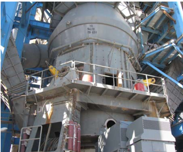
شکل (2)- نمایی از پروژه سیمان نهاوند که از دو آسیای غلتکی لوشه برای دیپارتمانهای مواد خام و سیمان استفاده شده است.
